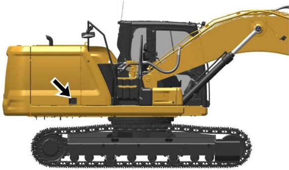
Рисунок 1 g06182545 Фильтр топливподкачивающего насоса расположен за дверцей доступа на правой стороне машины.
